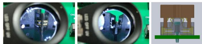
CXCシリーズは開放式頂部構造と冲圧簧片接触を採用します。それは自動化生産テストの理想選択肢。
